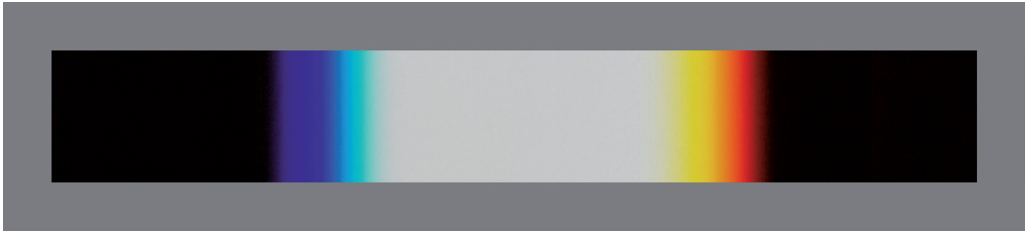
Abb. 1: Kantenspektrum eines hellen Streifens auf dunklem Grund.
